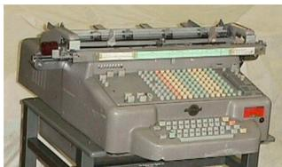
Nous avons également abordé la programmation, d'abord sur machine comptable mécanique. La programmation se faisait en plaçant des compteurs sur des réglettes, à l'arrière de la machine, la touche tabulation se déplaçant d'un compteur à l'autre, avec possibilité de « tirer un sous-total » qui virait le résultat dans le compteur suivant. Bref, on pouvait programmer la saisie d'un journal comptable avec totalisations.
